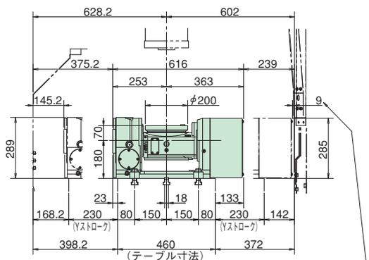
Y軸をフルストロークまで移動すると隙間が9mmしかないので、ストローク制限が必要となります。
