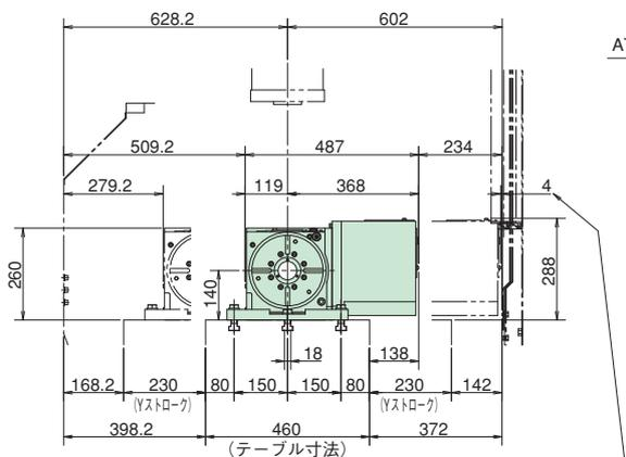
Y軸をフルストロークまで移動すると隙間が4mmしかないので、ストローク制限が必要となります。
