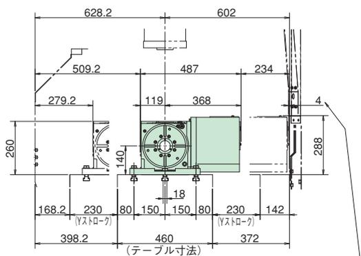
Y軸をフルストロークまで移動すると隙間が4mmしかないので、ストローク制限が必要となります。
