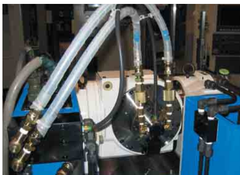
●ロータリジョイント完全内蔵(オプション)でシンプルで確実なジグ配管を実現 油路分配器完全内蔵(选择安装)简单可靠的治具配管
