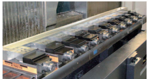
▲在3米长的M/C工作台上直线并列方式搭载10台虎钳
