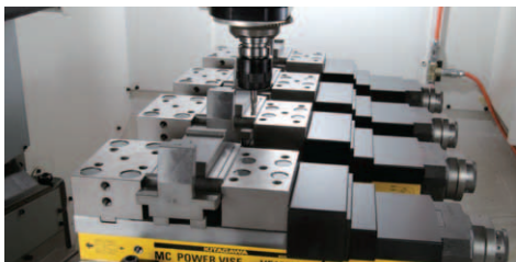
▲采用标准并列方法实现数个工件的同时加工, 大大降低加工成本
