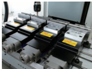
▲采用标准并列方法实现数个工件的同时加工，大大降低加工成本
