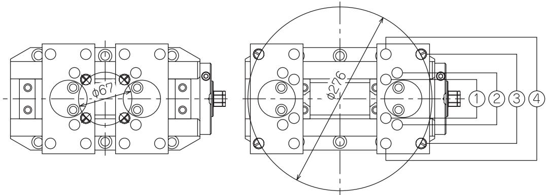
インサートを取付ける位置と把握するワーク径によりインサート把握面の角度が変わります。
