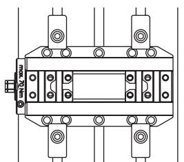
工作機械のT溝付きテーブルにクランプ器具を使用し取付。
