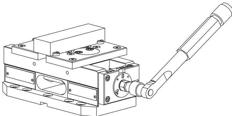
口金開閉用ハンドルにトルクレンチを使用し口金締付力の調製を行います。
