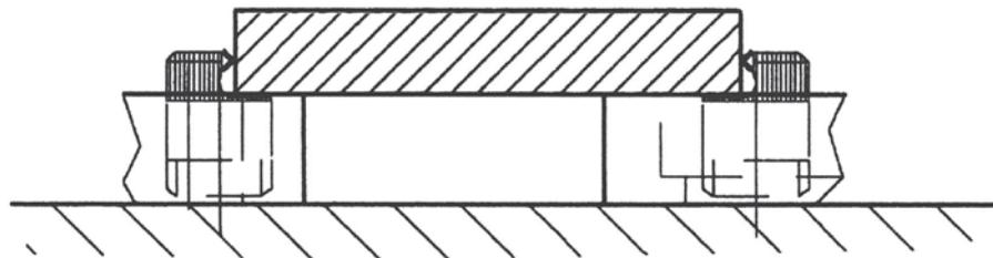
インサートの角錐のスパイクは、ワークピースに食い込み、確実にロックします。
