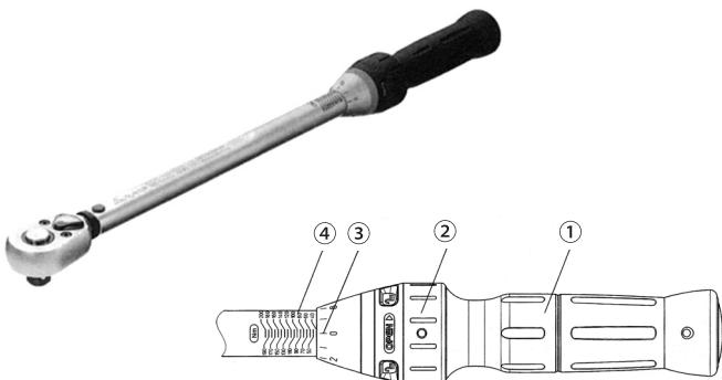
安全ロック②を「Open」の方へ、時計回りに回転させ、ハンドル①のロックを外します。
