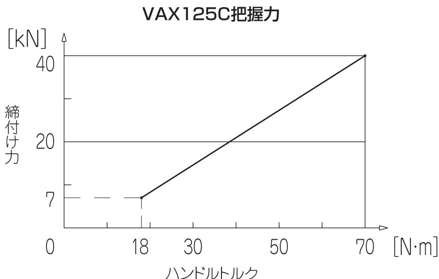
グラフに示すハンドルトルクと締め付け力の関係は目安です。締め付け力は把握力計等により確認を行い適切なハンドルトルクでご使用ください。
