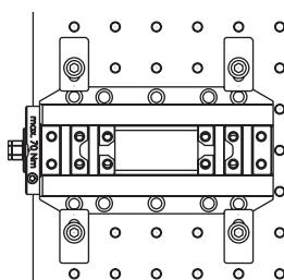
工作機械のネジ穴付きテーブルにクランプを使用し取付。
