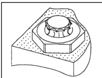
インサート（丸型）は、穴あけ加工など被削材を貫通した工具が爪に干渉する時にご使用下さい。
