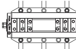
工作機械のT溝付きテーブルに取付ボルトM12で直接取付。
